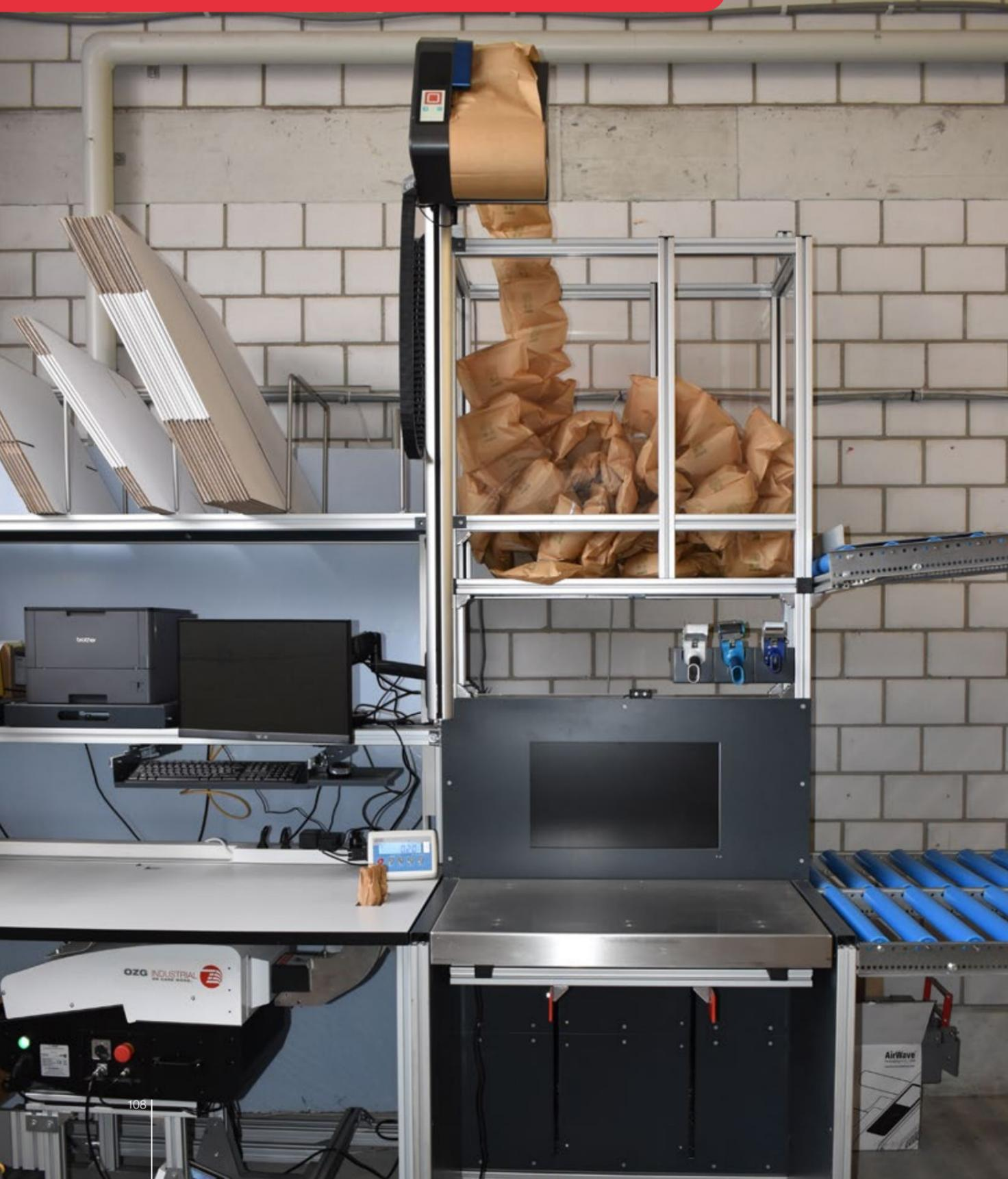
Ein massgeschneiderter Packtisch erlaubt es, diesen perfekt auf den vorhandenen Platz zu konzipieren, so wird der Raum ideal ausgenutzt. Zudem kann der Verpackungsprozess optimiert werden. Es geht darum die modularen Einzelteile perfekt zu kombinieren, damit Produkte in kürzester Zeit und mit möglichst geringem Aufwand optimal verpackt und lieferbar sind.
